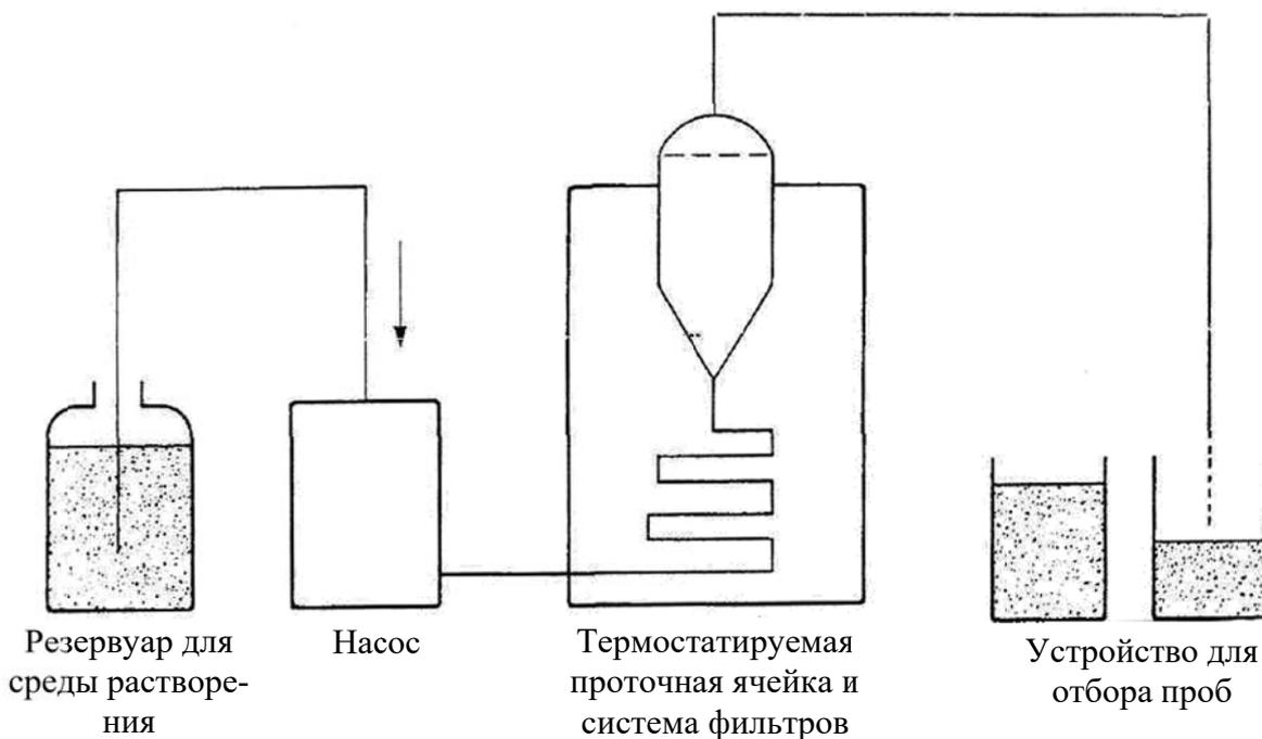
Рис. 3 – Схема аппарата III «Проточная ячейка»
