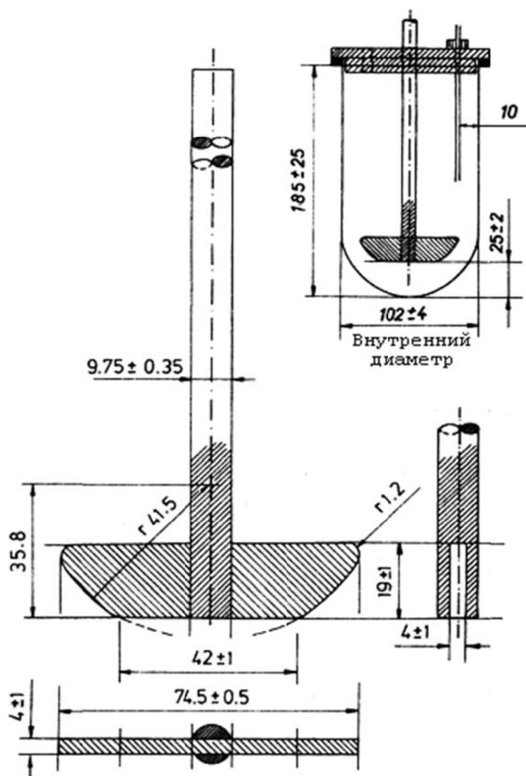
Рис. 2 – Аппарат II «Лопастная мешалка»
