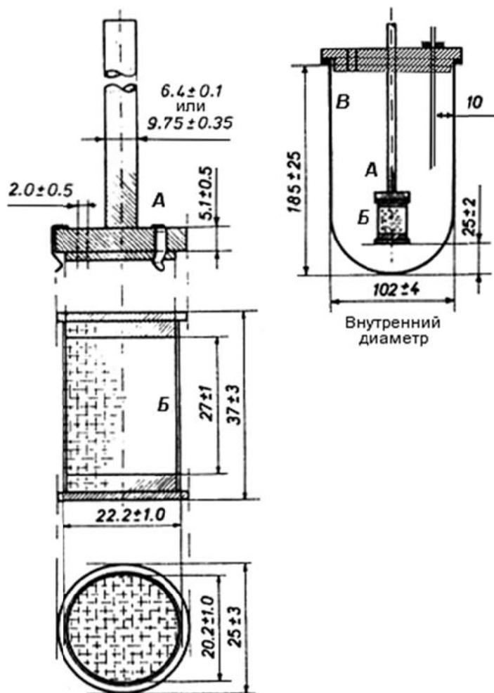
Рис. 1 – Аппарат I «Вращающаяся корзинка»
